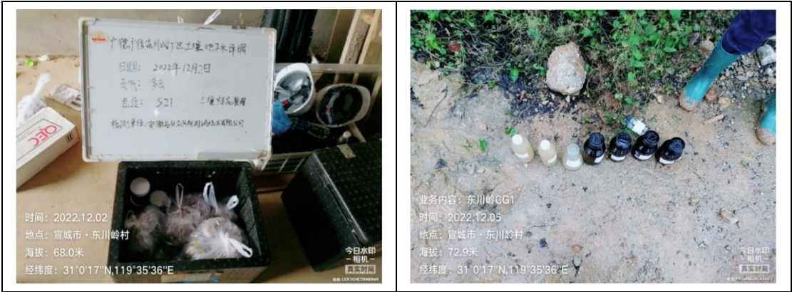
图 5-2-3 土壤和地下水样品保存过程图
