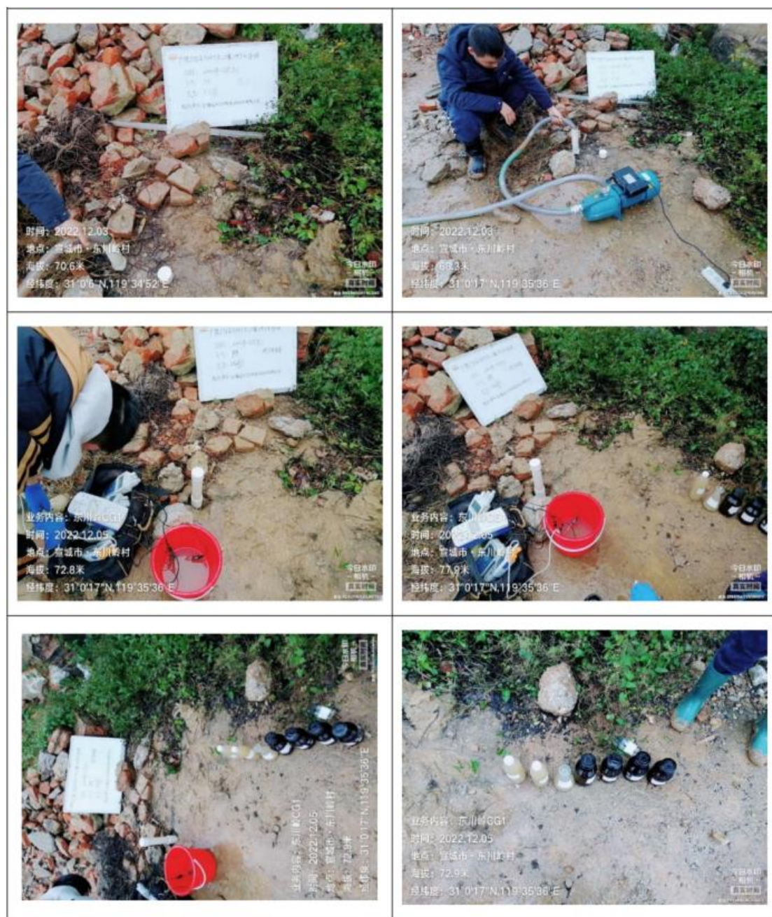
图 5-2-2 地下水样品采集过程图
