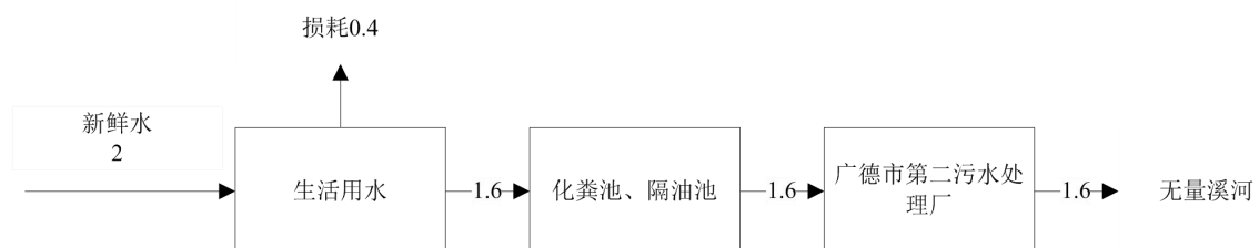
图 2-1 项目水平衡图 (t/d)
