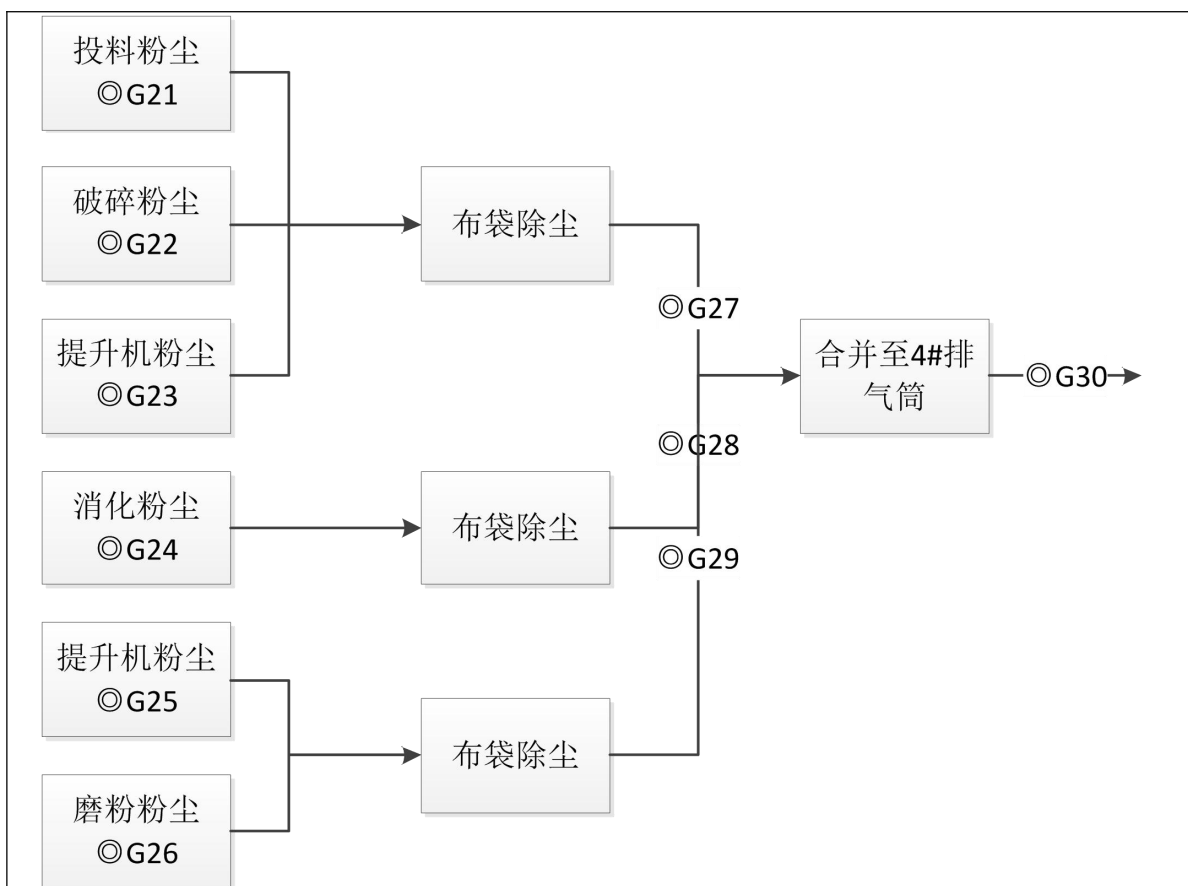
图 3-4 4#生产线有组织废气处理流程图及监测布点图
