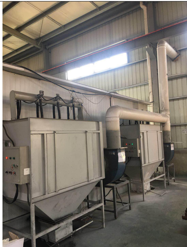
图 4-3 喷塑废气处理设备
