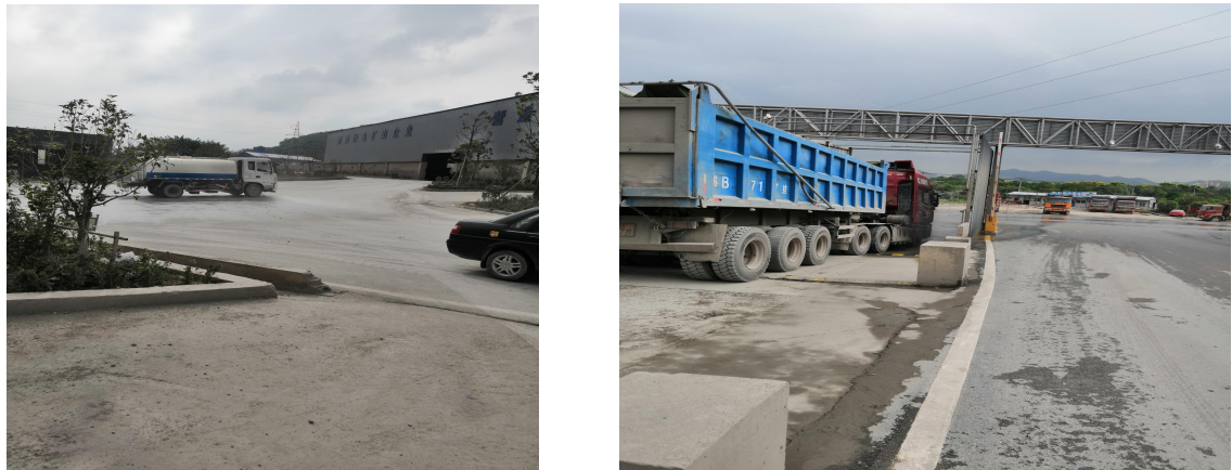
图 9-2 矿山洒水车和车辆冲洗平台
