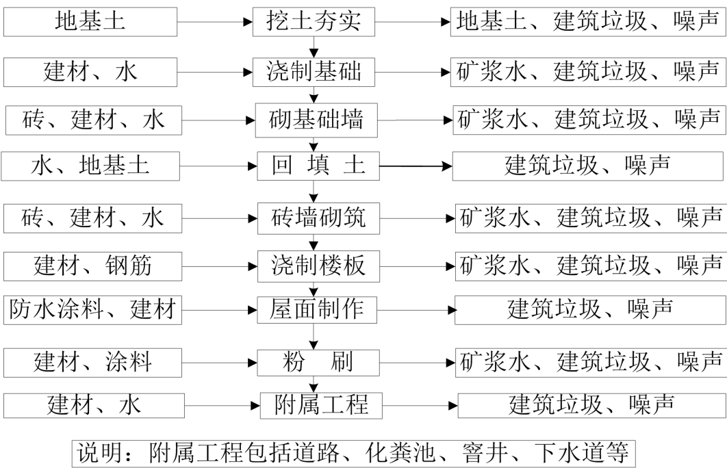
图 5-2 本项目施工流程简图
