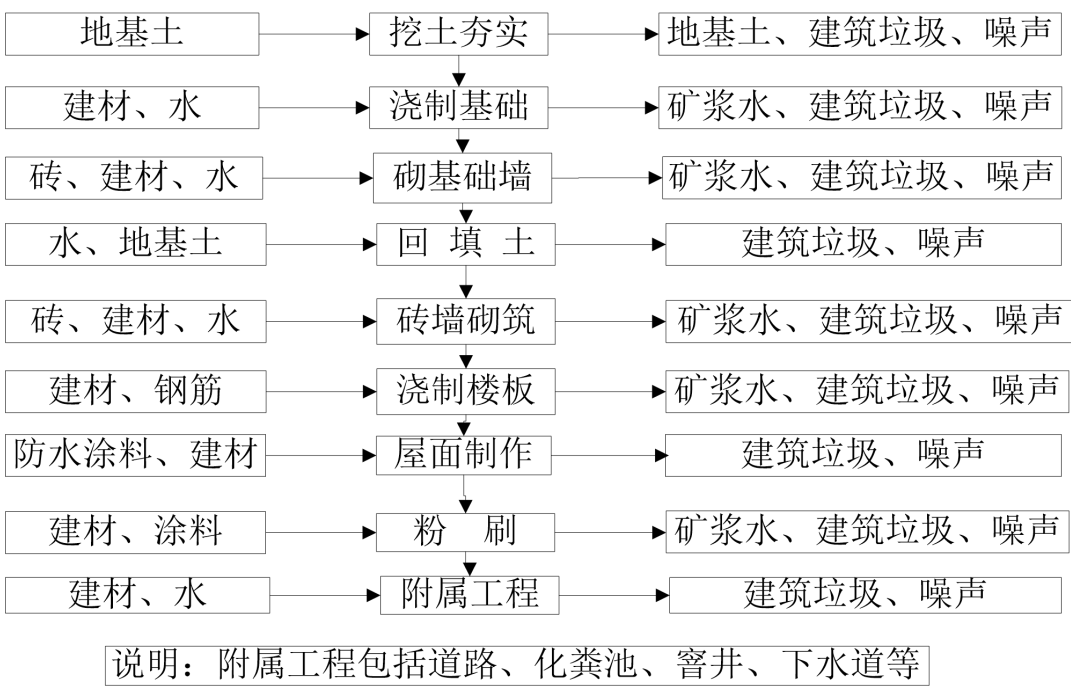
图 5-3 本项目施工流程简图
