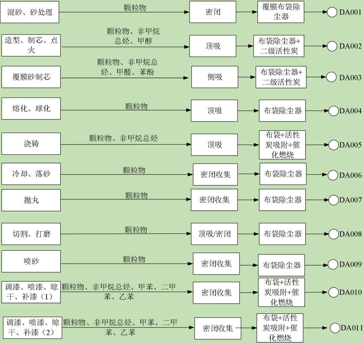
图 6.2-1 项目废气收集管线示意图
